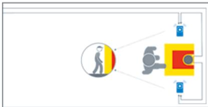
нарушение защитного поля запускает два EventCam, которые записывают видео
