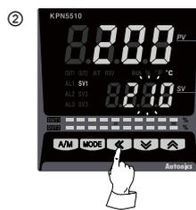
Press the key to move digit. (10<sup>0</sup>→10<sup>1</sup>→10<sup>2</sup>→10<sup>3</sup>→10<sup>0</sup>)
